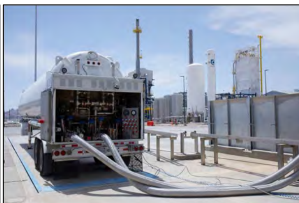
Liquid trailer voor transport van 4000 kg onder 1 tot 4 bar bij een cryogene temperatuur.
