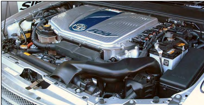
BOP ook klein en compact? Compacte brandstofcel systemen van een auto. De vermogens liggen ratio 150 kW.
