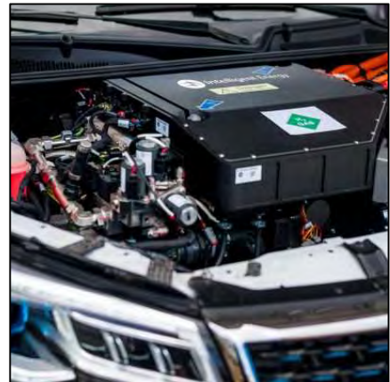
BOP ook klein en compact? Compacte brandstofcel systemen van een auto. De vermogens liggen ratio 150 kW.
