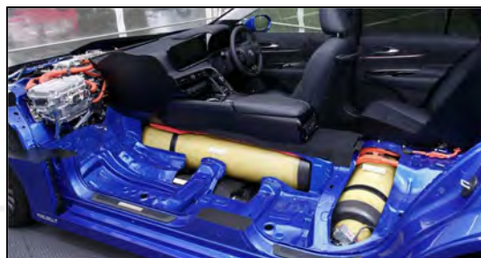
Toyota Mirai met inbouw van de waterstoftanks.
