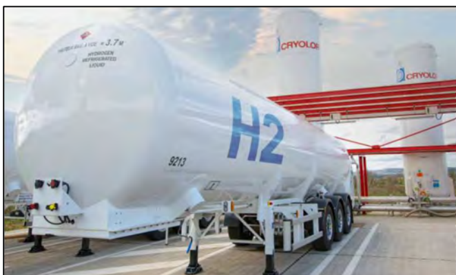
Liquid trailer voor transport van 4000 kg onder 1 tot 4 bar bij een cryogene temperatuur.
