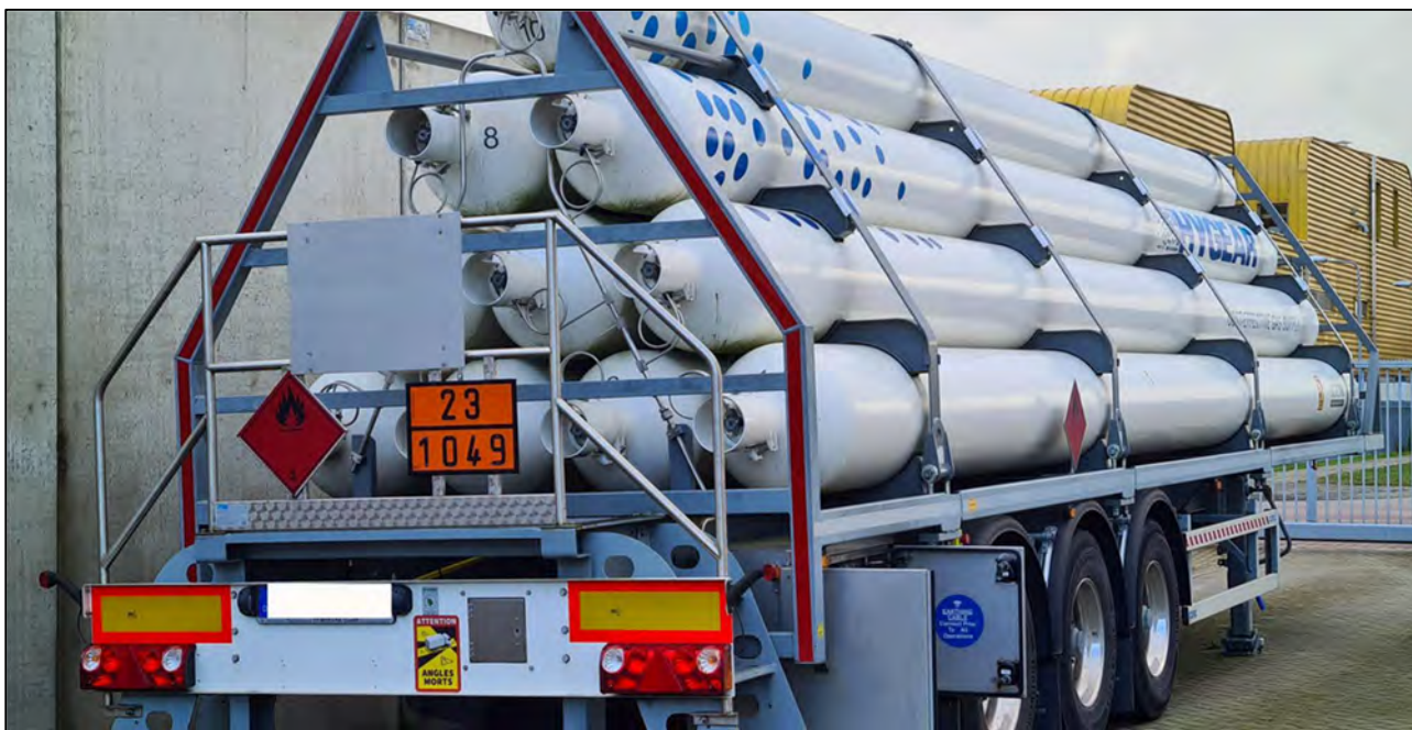
Opstelling van een tubetrailer met de verplichte symbolen.
