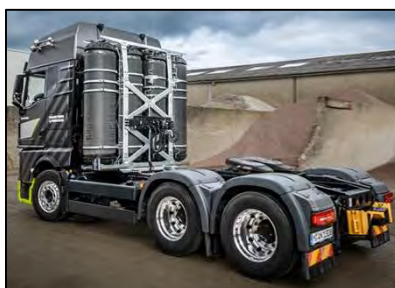
.Vrachtwagen op waterstof van MAN met de opstelling van de tanks.
