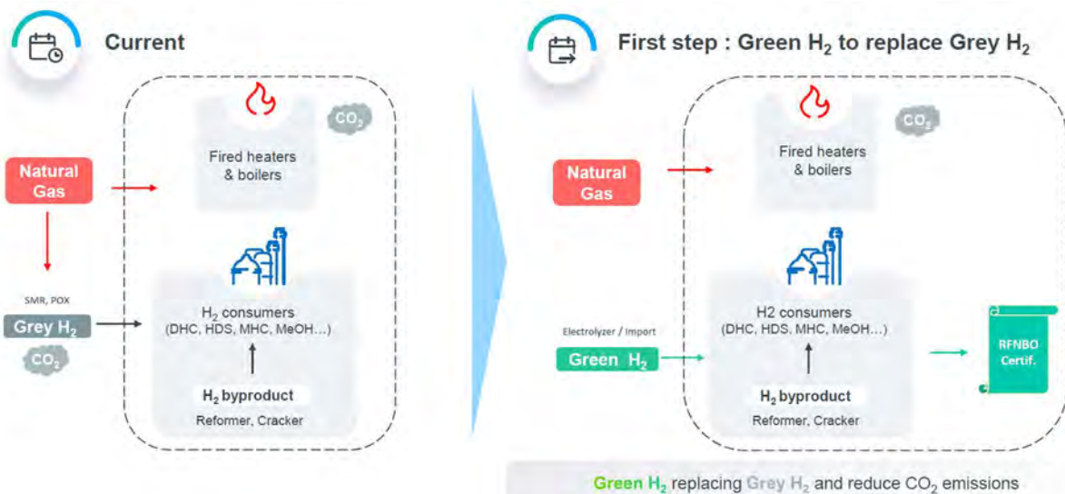
Schematische voorstelling raffinage – proces van waterstof. Bron: TotalEnergies.
