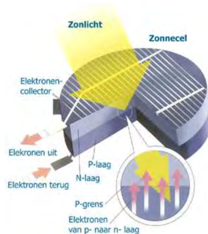
Werking van een zonnepaneel.
