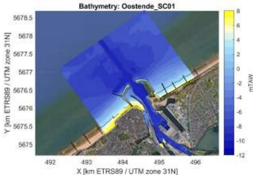
Figuur 5 – Modelbathymetrie in scenario SC01 met nieuwe kaaimuur.
